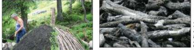
Dall'alto, inizio della combustione e carbone prodotto e fine processo.
